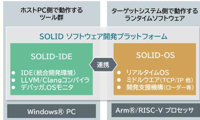
SOLID では、SOLID-OS に組み込んだデバッグ支援用ランタイムと連携させることにより、アドレスサンタイザによるバッファオーバーランなどの自動検出や、コンパイラ連携により簡単にコードカバレッジを表示すること、などを実現しています。また、他にも、スタック破壊などを実行時に自動検出したり、ソースコードの静的解析機能など、ソフトウェア品質向上と、開発効率向上に有効なデバッグ・解析支援機能を豊富にそろえています。
